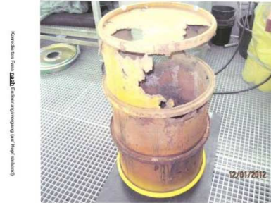
Fass aus der Lagerkaverne im AKW Brunsbüttel
